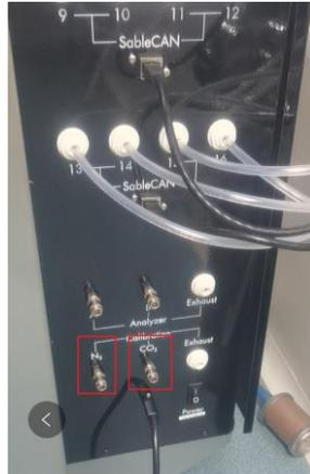
2、打开校正气体 N2 和混合 CO2 气体。分压阀打到 20psi 左右。
